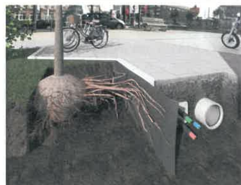
รูปที่ 2.16-1 ตัวอย่างรายละเอียดแผ่นป้องกันราก (Root Barrier)
